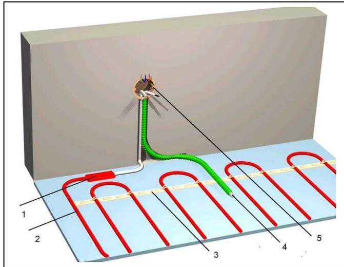
**Рис. 3.** Монтаж датчика температуры в системе “Теплый пол”.
